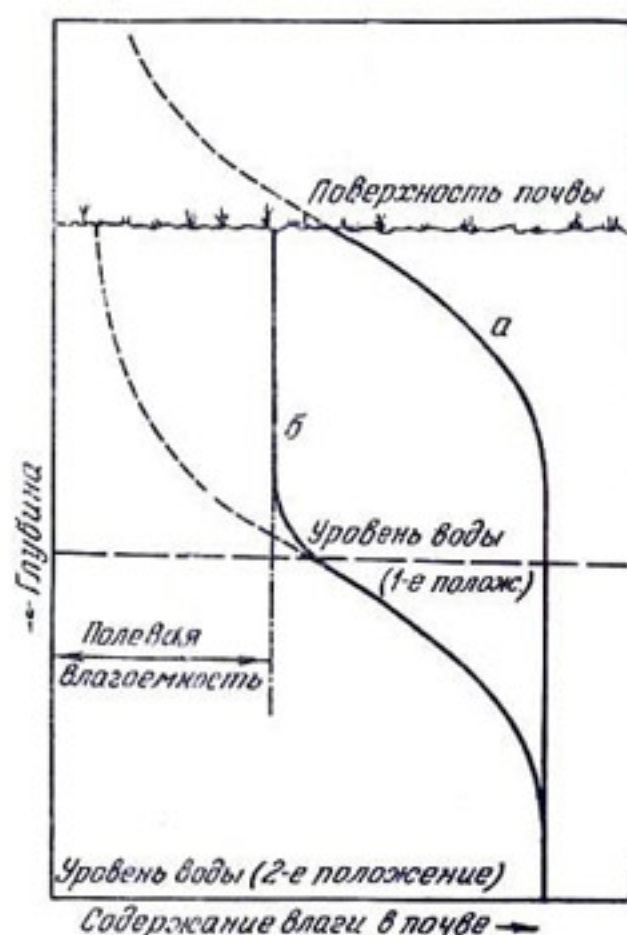
Рис. 11. Профили почвенной влажности при понижении уровня воды: а — 1-е положение (более ранняя стадия); б — 2-е положение (более поздняя стадия).
