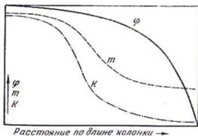
Рис. 23. Изменение содержания влаги ( m ), гидравлической проводимости ( k ) и потенциала ( \phi ) вдоль колонки гипотетической ненасыщенной почвы, пропускающей постоянный поток воды.
