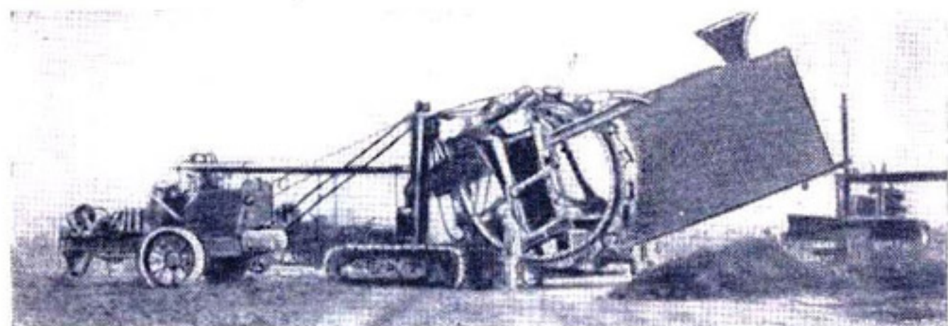
Рис. 163. Трубоукладочная машина в транспортном положении.
