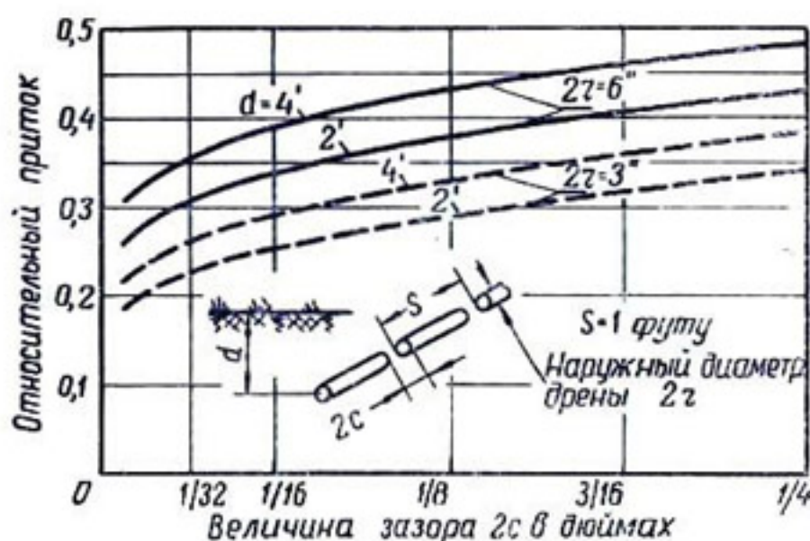
Рис. 139. Зависимость между относительным притоком в дрены и величиной зазоров. По теоретическим расчетам Киркхема (1950).
