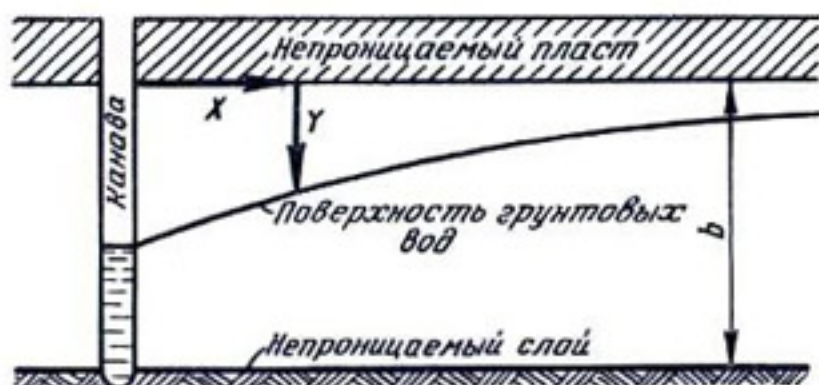
Рис. 40. Схема и обозначения, используемые в анализе Ферриса.
