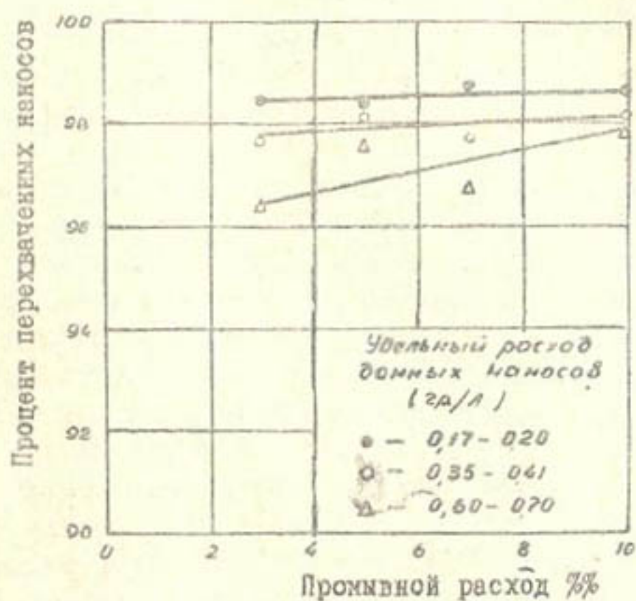
Рис. 6 Зависимость процента перехваченных наносов от величины промывного расхода воды (песок № 4).
