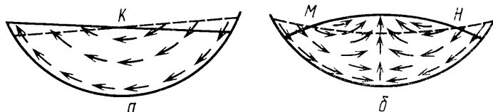
Рис. 3.3. Одноузловые (а) и двухузловые (б) сейши.
