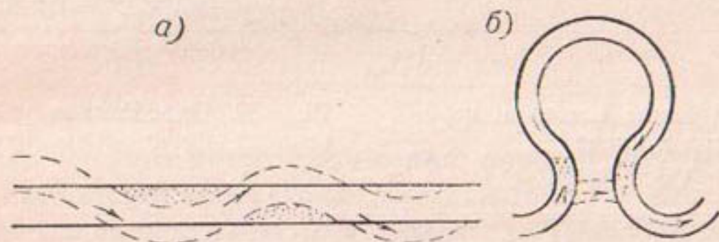
Рис. 37. Процесс образования излучин (а) и староречий (б) при прорыве излучин.
