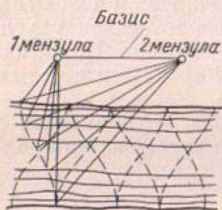
Рис. 108. Схема промеров по косым галсам.
