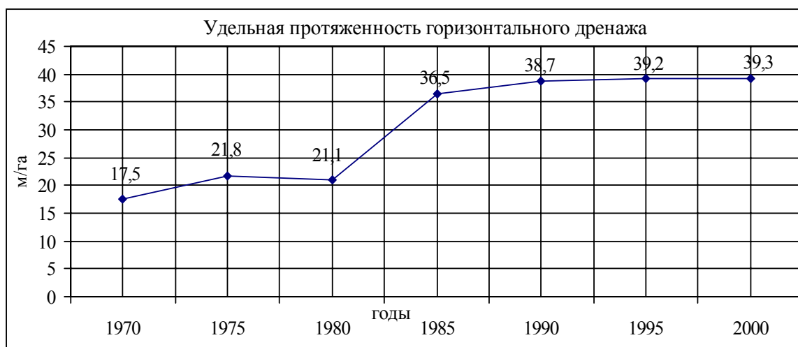
Рис. 6.5.1.4 Изменение удельной протяженности КДС
