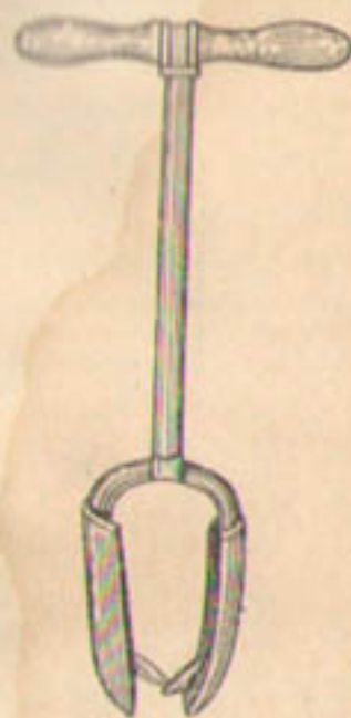
Рис. 111. Почвенный бур, применяемый для бурения ям под столбы. Подобными бурами малого диаметра пользуются для исследования распределения оросительной воды в почве.
