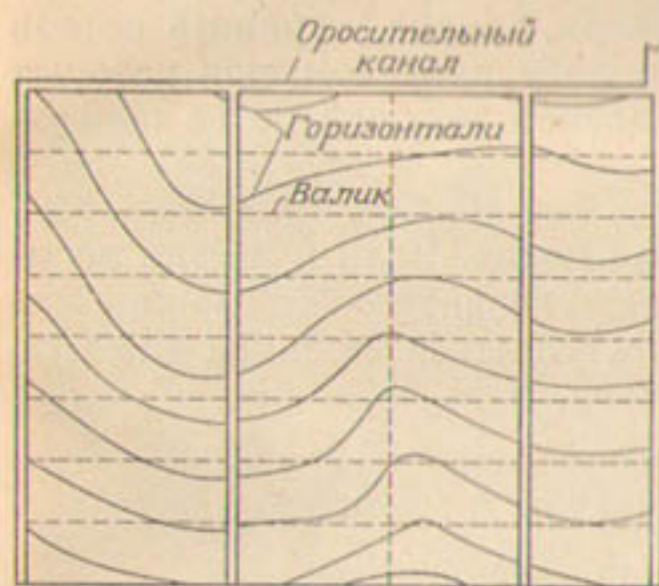
Рис. 74А. Разбивка орошаемого участка на чеки.
