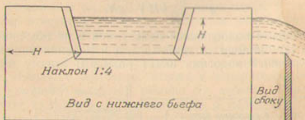
Р и с. 14. Трапециoidalный водослив Чиполетти.
