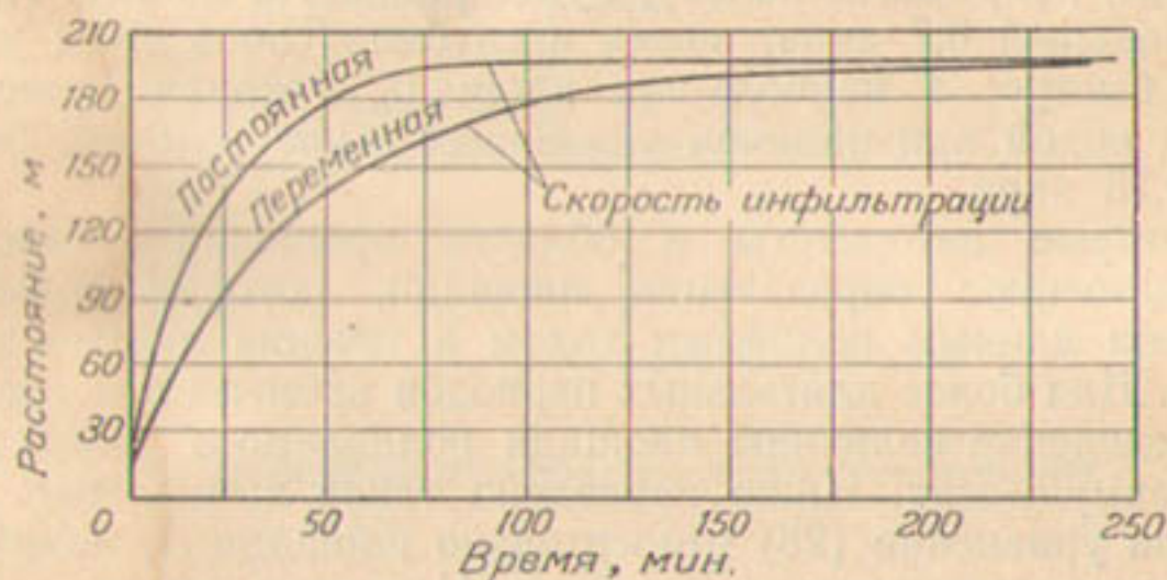
Рис. 71. Зависимость пути, пройденного водой при переменной и постоянной скоростях фильтрации, от времени.
