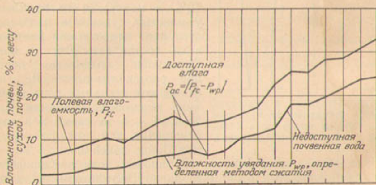
Рис. 122. Полевая влагоемкость, влажность увядания и доступная влага почвы в 21 пункте штата Южная Каролина.
