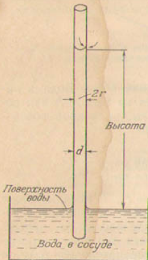
Рис. 104. Схема, показывающая подъем воды в капиллярной трубке над поверхностью воды в сосуде под действием поверхностного натяжения.
