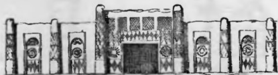
Рис. 254. Приемы декоративной обработки фасада хорезмской жилой усадьбы
