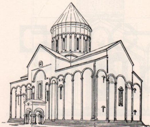
Рис. 55. Кафедральный собор в Ани. Армения. Реконструкция купола (по автору)
