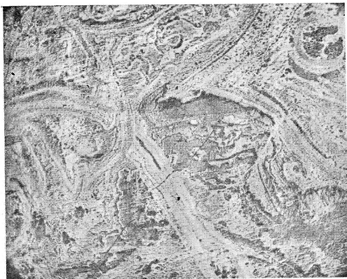
Рис. 3. Микроструктура окарины \text{Fe}_2\text{O}_3 при увеличении 300
