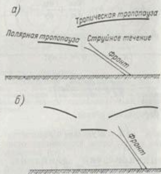
Листовидная структура тропопаузы. а — разрыв температуры в области полярного фронта, б — воронка тропопаузы над глубоким циклоном.
