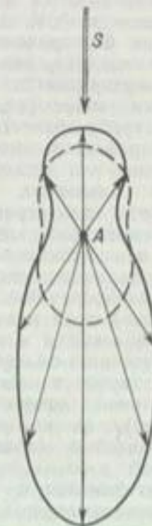
Атмосферная индикатриса рассеяния. Векторами указана интенсивность рассеяния в разных направлениях от рассеивающей частицы А. S — направление падающей радиации. Прерывистой линией для сравнения дана индикатриса молекулярного рассеяния.
