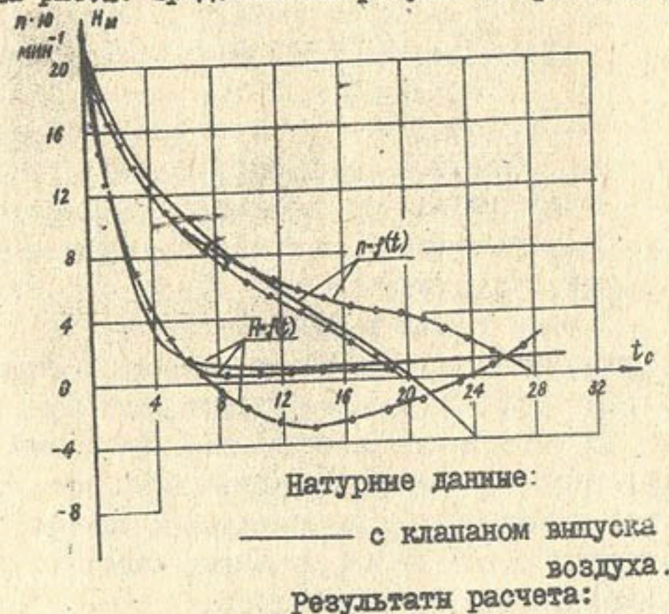
Рис. 2. Изменение давления в трубопроводе и частоты вращения отключенного насоса 2400В-25/40 при работающем насосе 1600В-10/40 на ДГНС.
