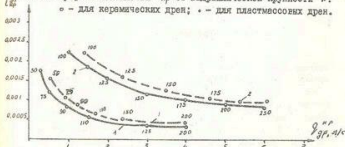
Рис. 3. График зависимости i_{кр} от q_{др} при W = 3,0 мм/с (1 — пластмассовый дренаж с искусственным или комбинированным фильтром) и 8,0 мм/с (2 — керамический дренаж) (числа у линий — диаметры труб).
