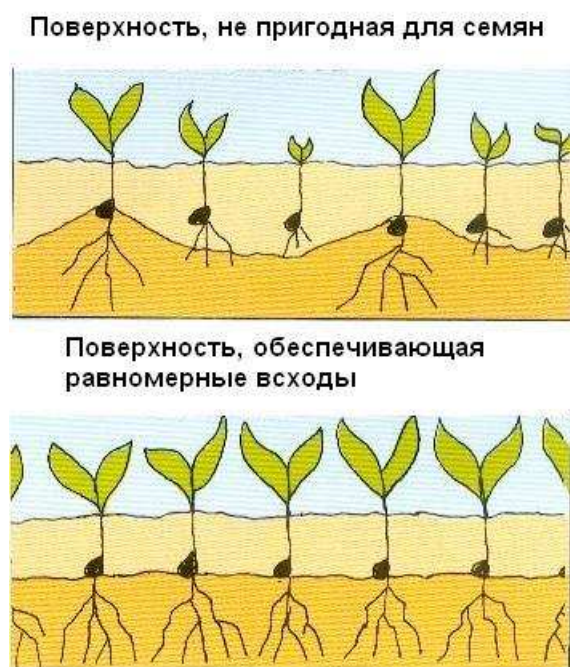
Рис. 5 - Разница условий развития семян при плохой и хорошей поверхности подстилающего слоя с естественной структурой пор
