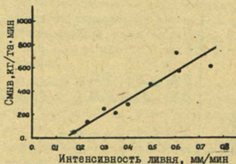
Рис.2. Зависимость склонового смыва от интенсивности ливня.
