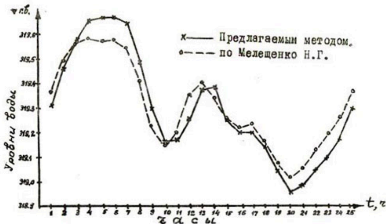
График колебаний уровня воды в конечном створе канала в течение суток.
