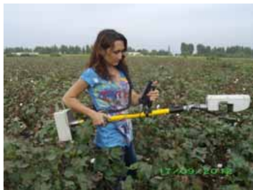
Рис. 1 - Измерения NDVI прибором GreenSeeker
