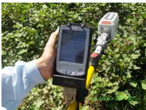
Рис. 1 - Измерения NDVI прибором GreenSeeker
