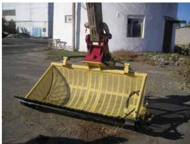
Рис. 2 – Установка нового сменного рабочего органа на экскаватор
