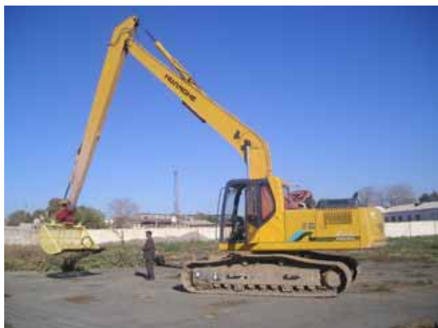
Рис. 1 – Гидравлический экскаватор с навешанным ковшом-косилкой
