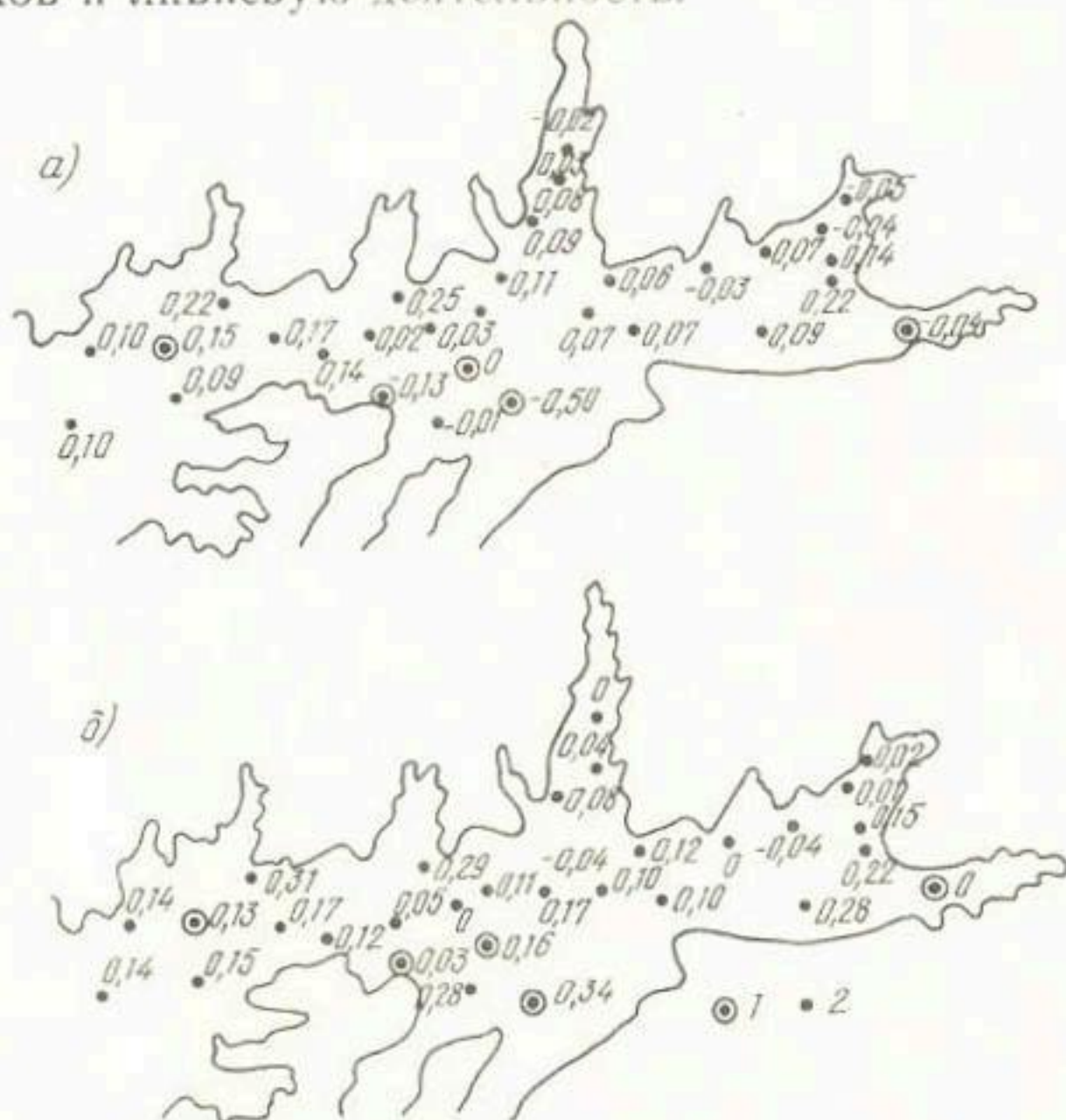
Рис. 1. Изменение средней суммы осадков с высотой \left( \frac{1}{\bar{Q}} \frac{\Delta Q}{\Delta z} \right) на 100 м за холодный (а) и теплый (б) периоды по данным наблюдений гидрометстанций (1) и постов (2)
