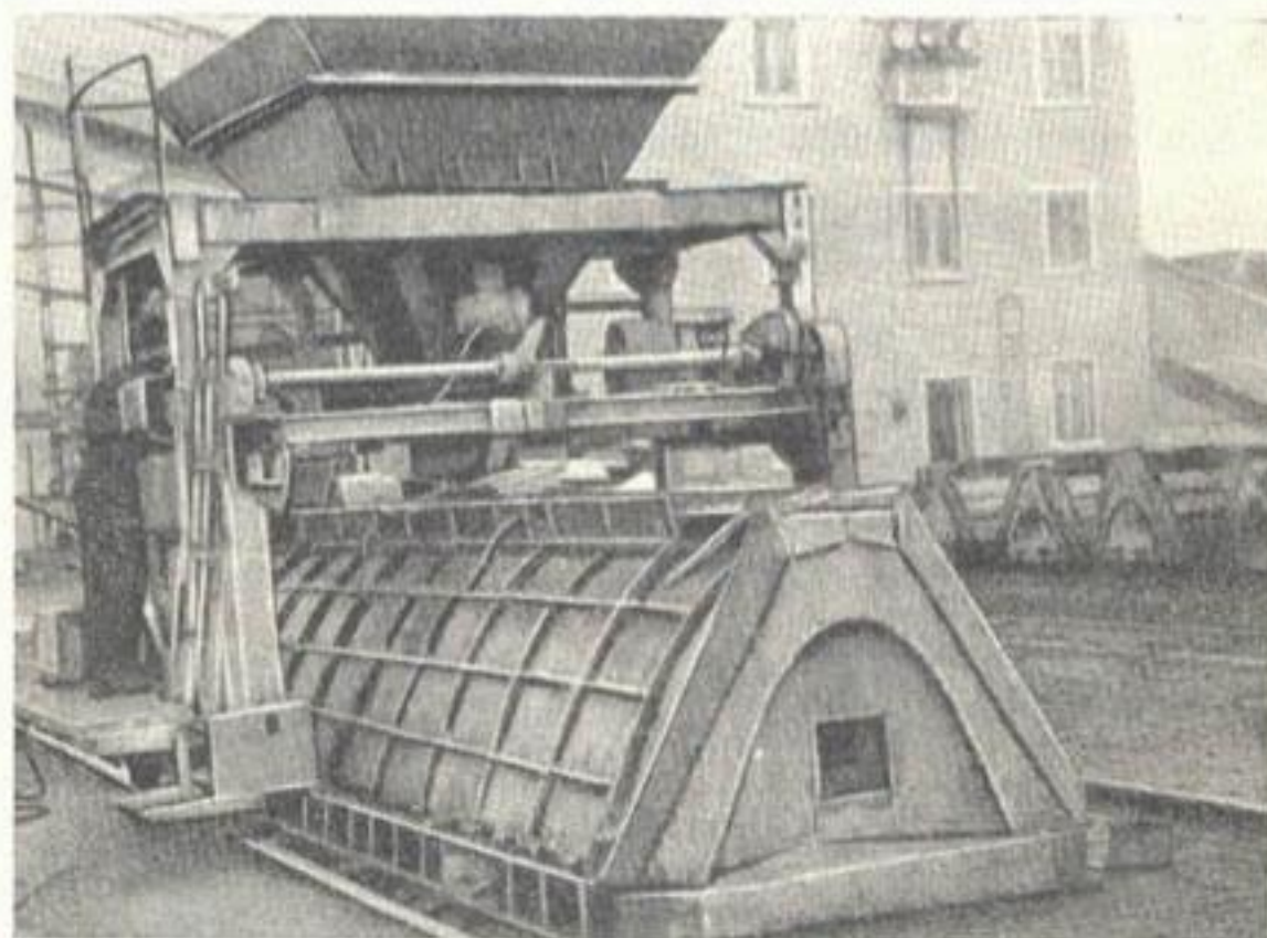
Рис. 116. Формовка лотков глубиной 1 м на виброплощадке.
