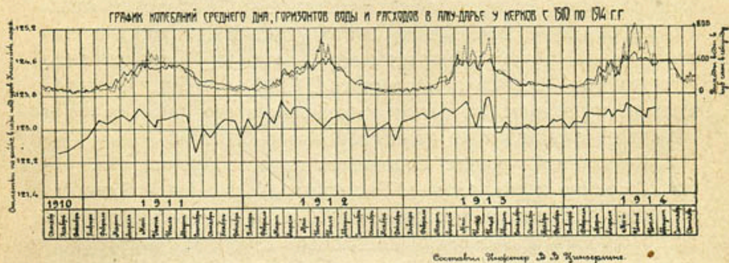
Рис. 4. График колебания среднего дна Аму-Дарьи у Керков.
