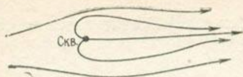
Рис. 4.2.9. Суперпозиция радиальной вынуждающей скорости и естественного фильтрационного потока
