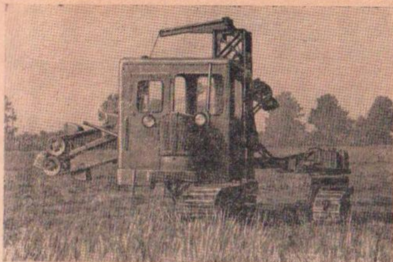
Рис. 25. Общий вид многоковшового экскаватора поперечного копания ЭМ-152А.
