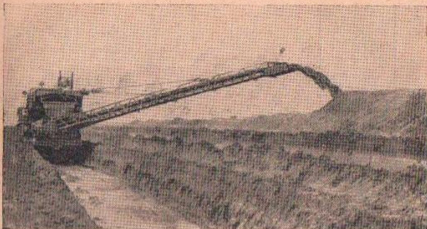
Рис. 2. Землеройно-фрезерная машина ЗМФ-2 в работе.
