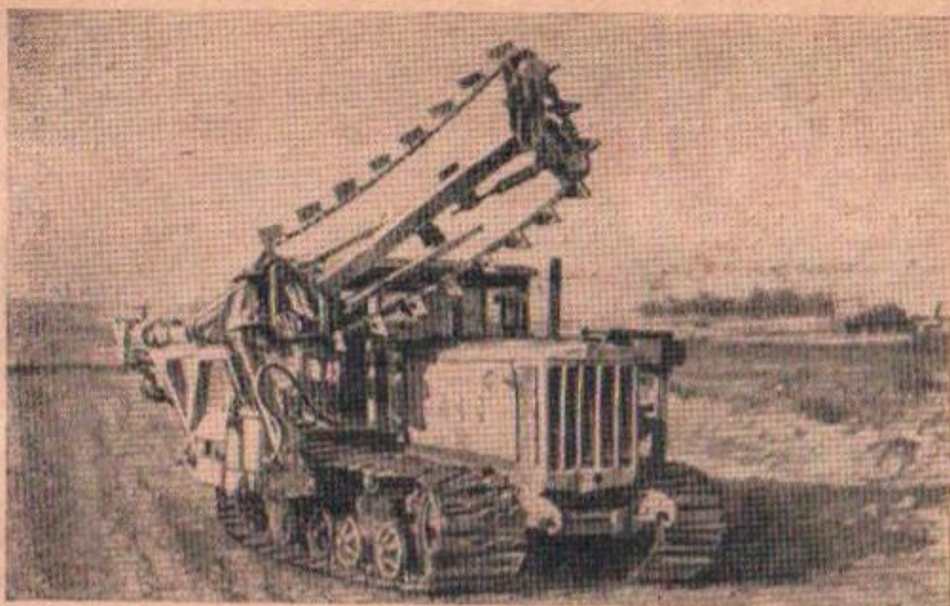
Рис. 19. Общий вид каналоочистителя Д-490М со скребковой цепью.
