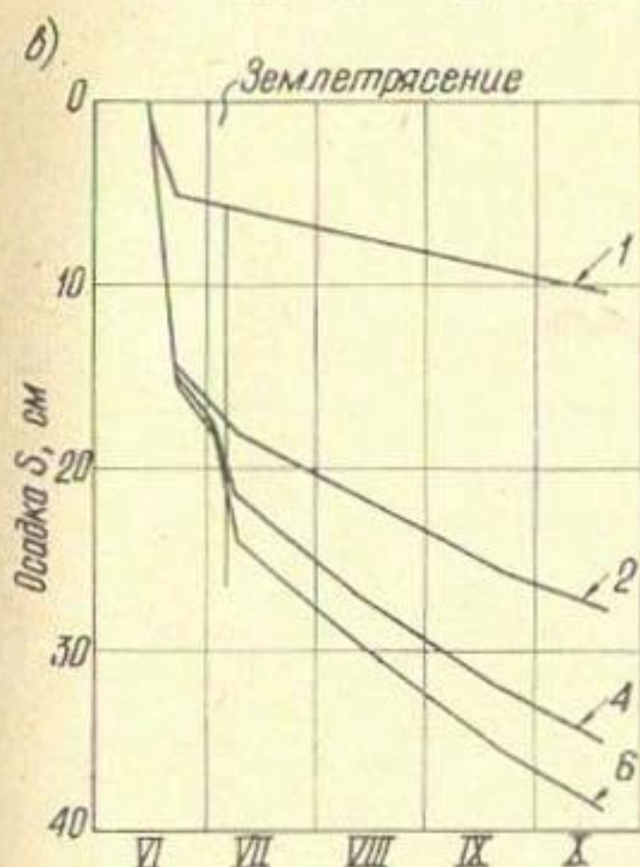
Рис. I.13. График наполнения водохранилища (а), осадки точек ядра (б), верхней (в) и нижней (г) призм плотины Инфернильо
