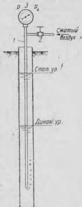
Рис. 9. Пневматический указатель уровня: 1—трубка малого диаметра; 2—вентиль; 3—чувствительный манометр.
