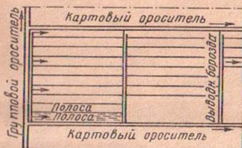
Рис. 18. Схема полива карты по полосам.
