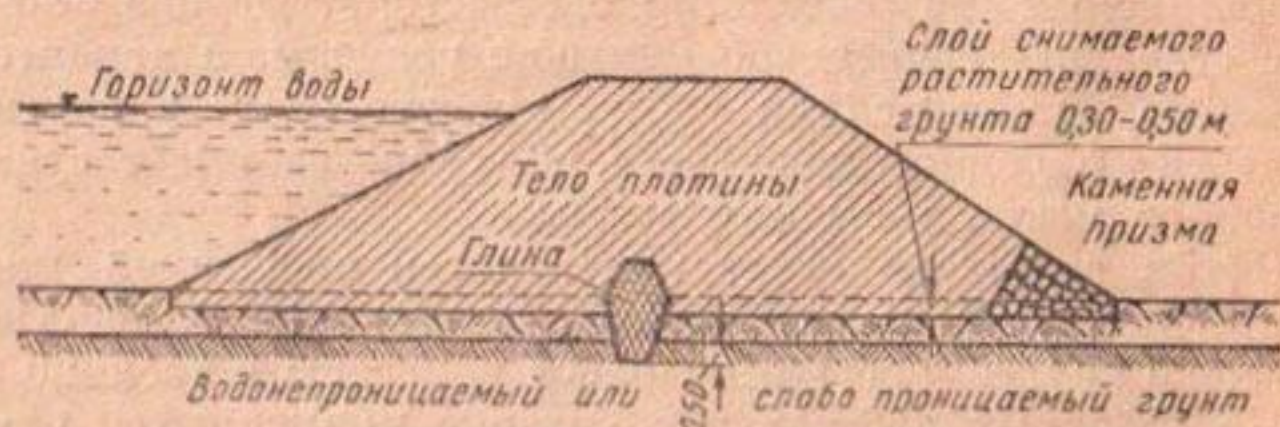
Рис. 38. Поперечный разрез земляной плотины
