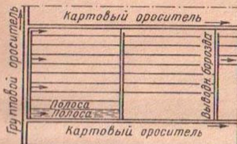
Рис. 18. Схема полива карты по полосам.
