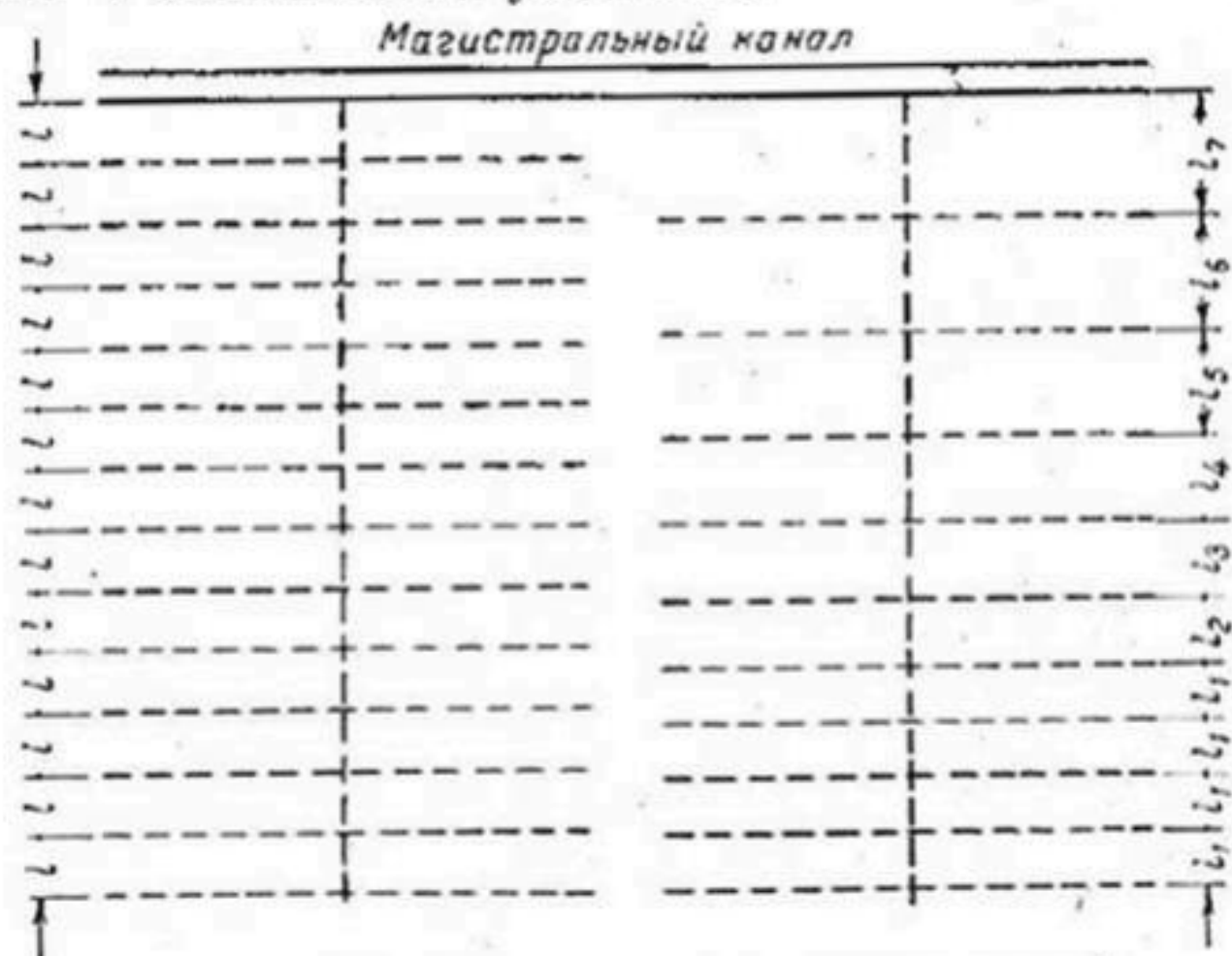
Расположение дренажных систем на притеррасном ключевом болоте.
