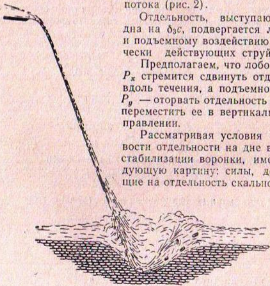
Рис. 2. Схема размыва скального основания падающей струей воды.
