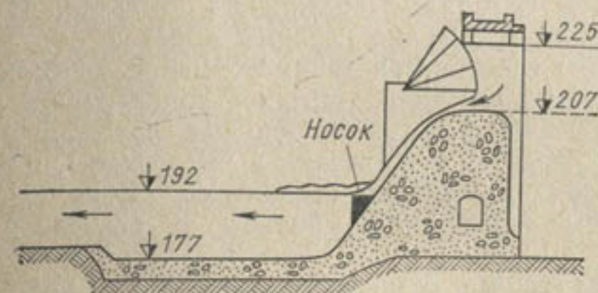
Рис. 9. Профиль водослива, рекомендуемый для плотины Лоуер-Гранит.
