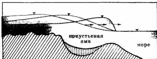
Схема образования приустьевой ямы.
