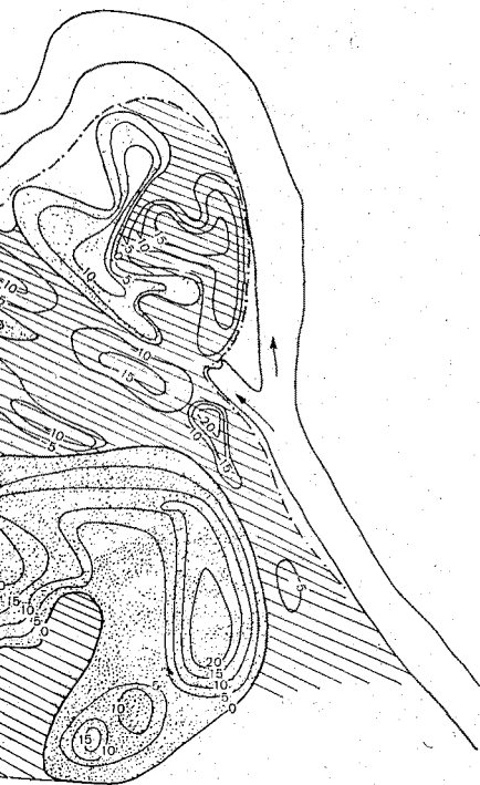
Рис. 61. Деформации поверхности поймы р. Полонети в районе с. Заречье (в см) за одно половодье (niveliroвки 1957 и 1958 гг.).
