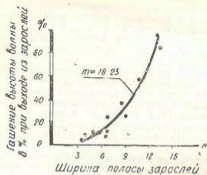
Рис. 3. График зависимости гашения высоты волны от ширины зарослей гребенщика.
