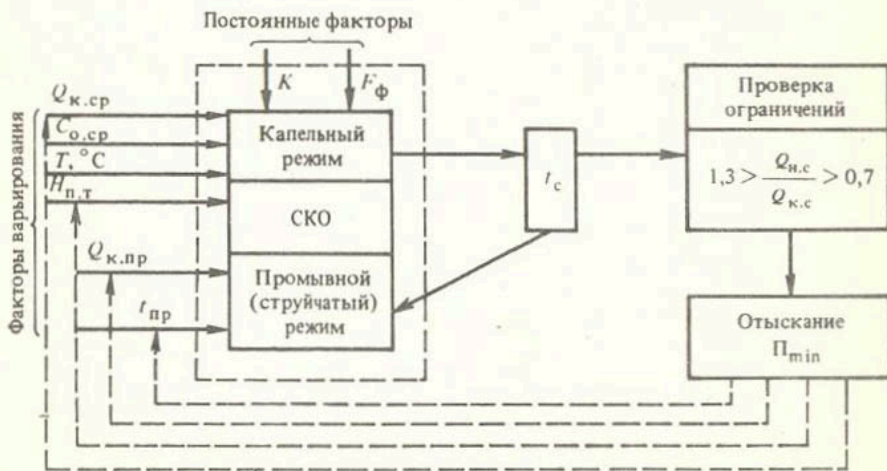
Рис. 2. Структурная схема оптимизации работы поливной сети СКО
