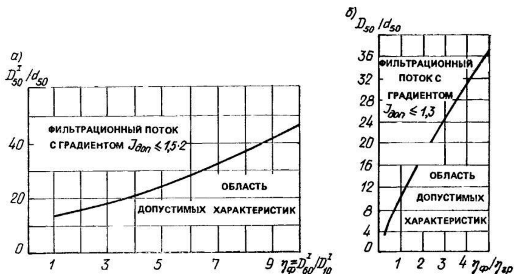
Рис. 9.7. Кривые для подбора состава первого слоя фильтра D_{60}/D'_{10} \leq 10 а — при движении воды снизу вверх на песчаном основании; б — при боковом движении воды при I \leq 1,3 d_{60}/d_{10} \leq 10
