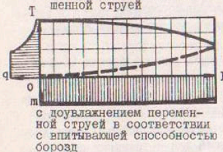
Рис. I. Циклограммы разновидностей технологии водораспределения (по тупым и проточным бороздам): T - продолжительность; L - длина борозды; q - поливная струя; m - поливная норма; — время увлажнения; - - - - время добегаия
