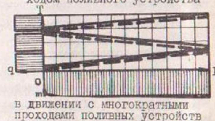
Рис. I. Циклограммы разновидностей технологии водораспределения (по тупым и проточным бороздам): T - продолжительность; L - длина борозды; q - поливная струя; m - поливная норма; — время увлажнения; - - - - время добегаия
