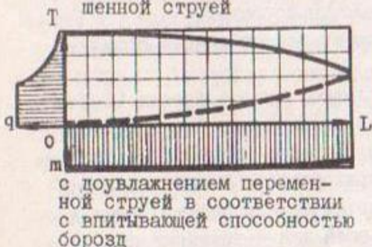
Рис. I. Циклограммы разновидностей технологии водораспределения (по тупым и проточным бороздам): T - продолжительность; L - длина борозды; q - поливная струя; m - поливная норма; — время увлажнения; - - - время добега
