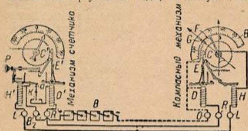
Фиг. 147. Схема работы вертушки Отта, тип VIIh.
