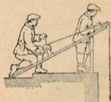
Фиг. 126. Опускание вертушки с моста.
