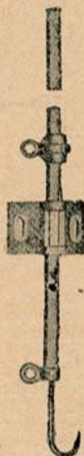
Фиг. 43. Крючковая рейка — иной тип.
