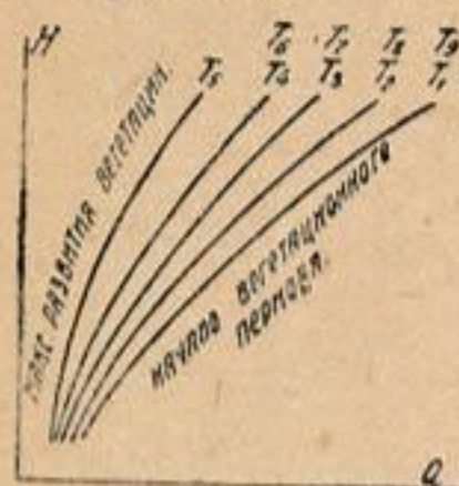
Фиг. 245. Связь расходов с уровнями при наличии водной растительности.
