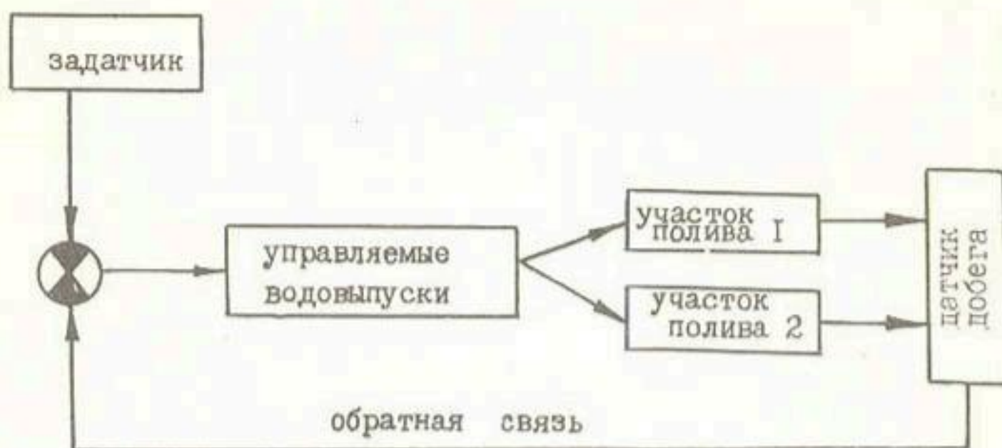
Рис.5. Структурная схема системы для бороздкового полива с широтно-частотным регулированием поливных струй
