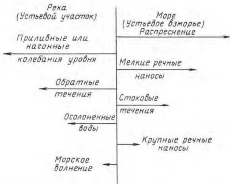
Рис. 1.10. Схема взаимодействия реки и моря в устьевой области реки
