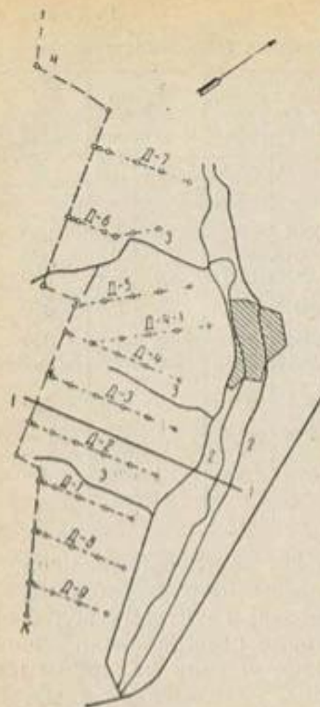
Рис. 23. Схема расположения ирригационной и дренажной сети на полях Марьинской опытной станции:
