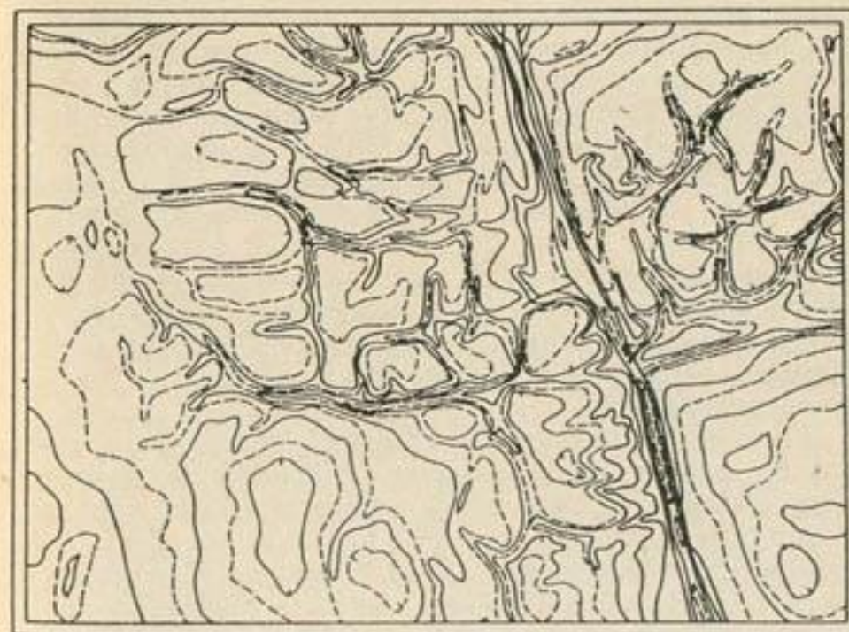
Рис. 10. Ирригационный рельеф (площадь участка около 300 га). Сплошные горизонталы — через 1 м, штриховые — через 0,5 м.
