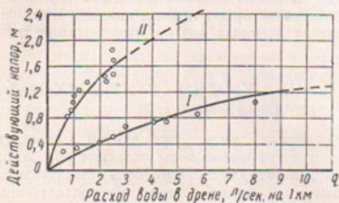
Рис. 163. Зависимость расхода воды в дренах от действующего напора.
