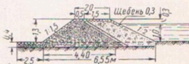
Рис. 201. Устройство перемычки из камня с земляной отсыпью.
