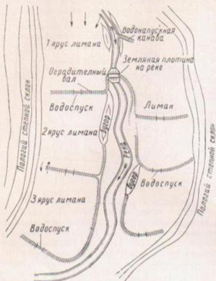
Рис. 197. Схема устройства ярусных лиманов в пойме реки.
