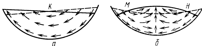
Рис. 3.3. Одноузловые (а) и двухузловые (б) сейши.
