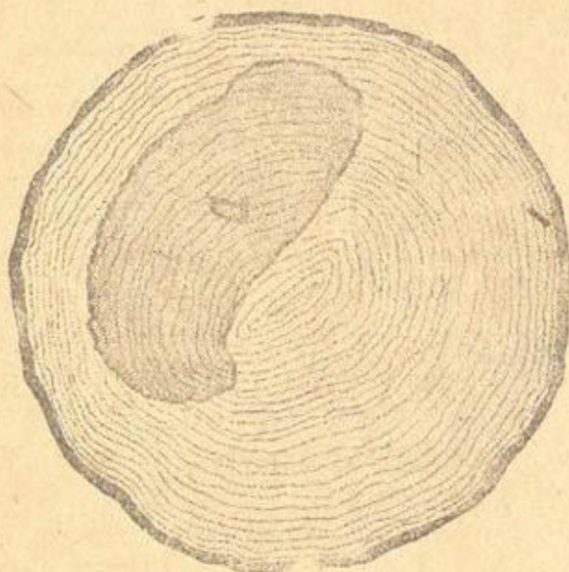
Рис. 3—Гниль (а) поражает часть торца. Определение возраста дерева возможно полностью; отдельные кольца возможно измерить по разным концам диаметра ствола. Образец годен.
