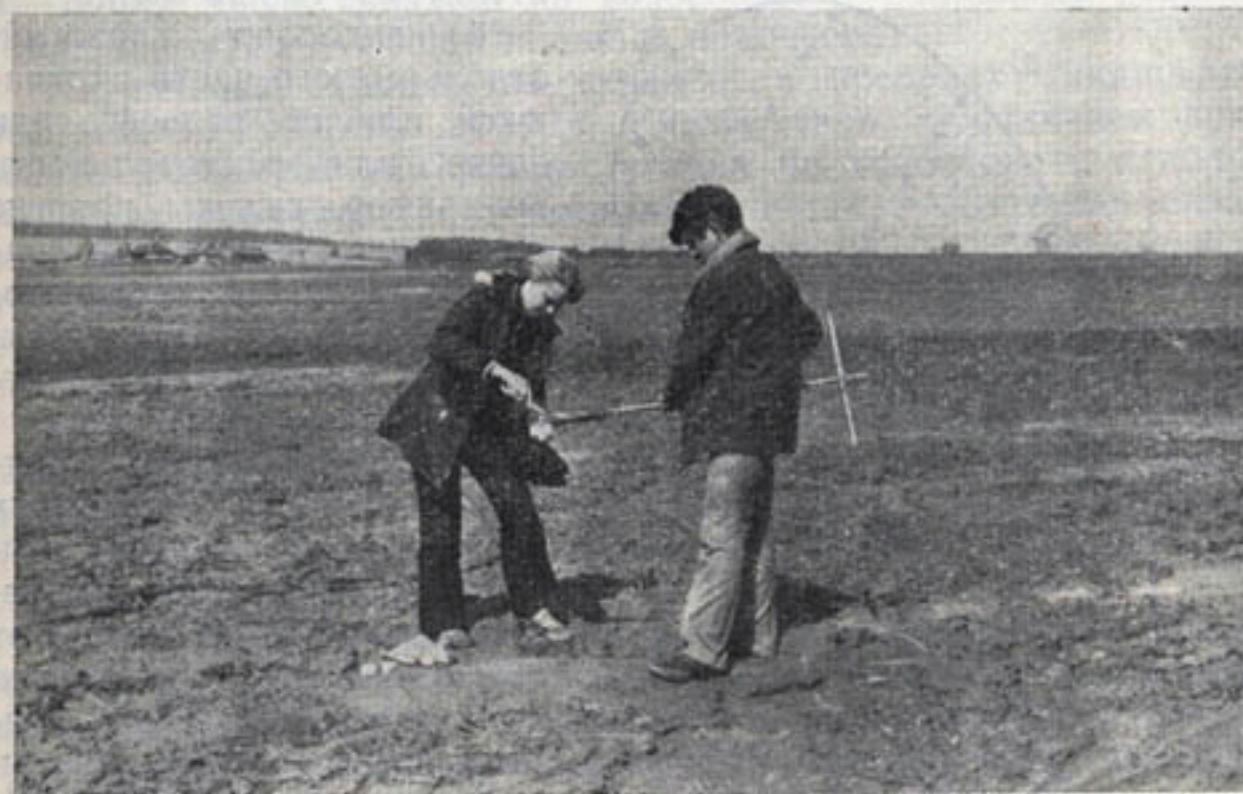
Рис. 23. Отбор проб почвы с помощью бура АМ-26.
