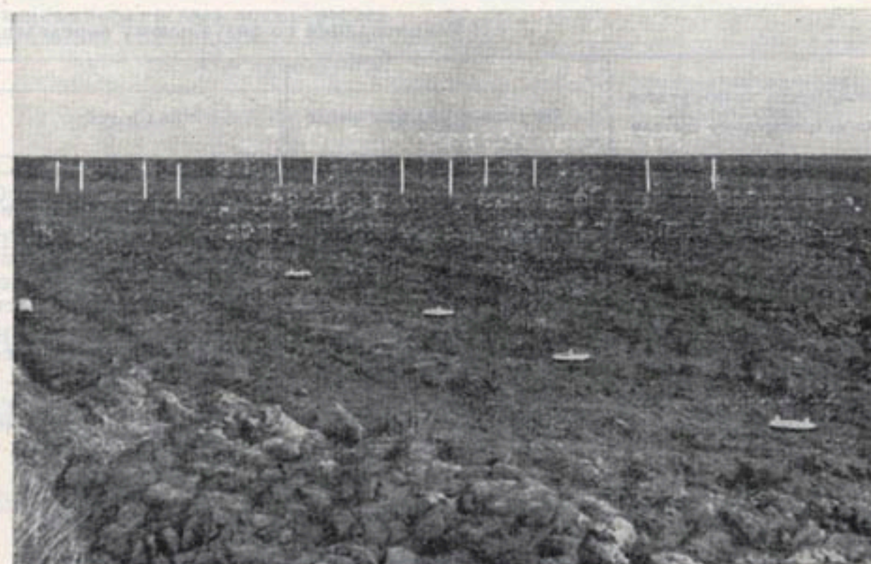
Рис. 16. Общий вид почвенноиспарительной и снегомерной площадок (испарители ГГИ-500 и постоянные снегомерные рейки).
