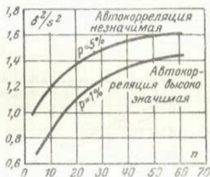
Рис. 1-5. Отношение Неймана \delta^2/s^2 для выявления значимости автокорреляции ( n — число членов в выборке).
