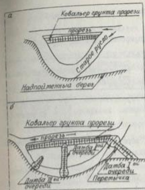
Рис. 1. Схемы производства русловыправительных работ на р. Амударье: *
