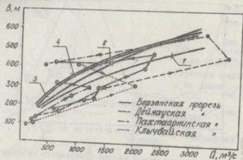
Рис. 3. График изменения ширины прорези в зависимости от расхода воды
