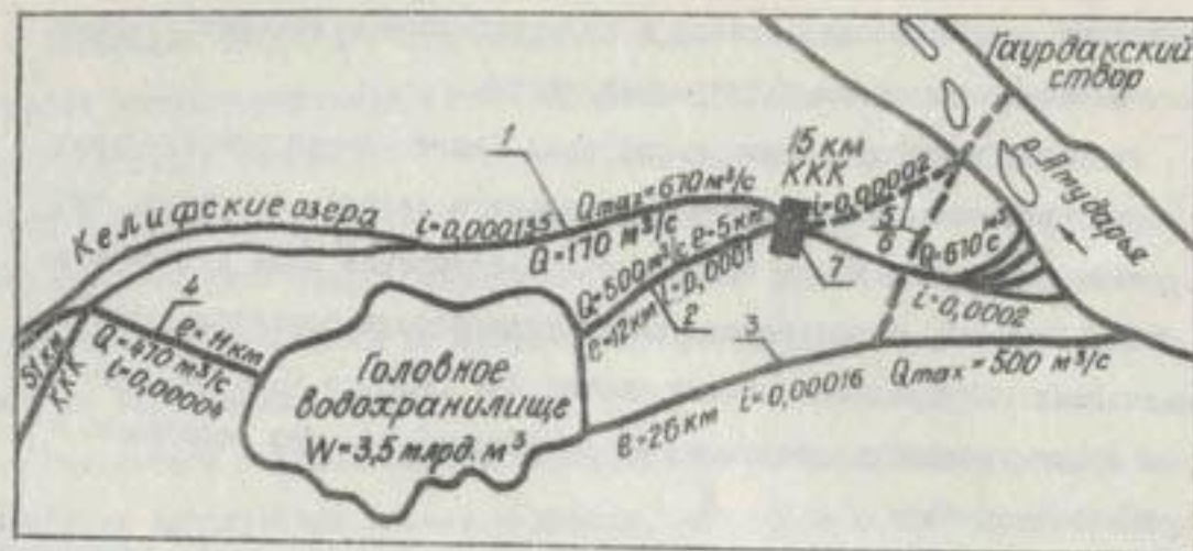
Рис. 2. Схема комплекса сооружений на головном участке Каракумского канала
