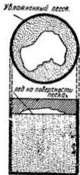
Рис. 203. Результаты опыта Сумгина над замораживанием увлажненного песка.
