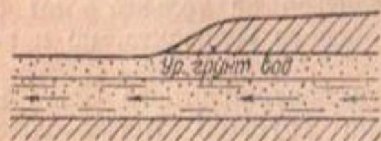
Фиг. 2. Выход грунтового потока на дневную поверхность
