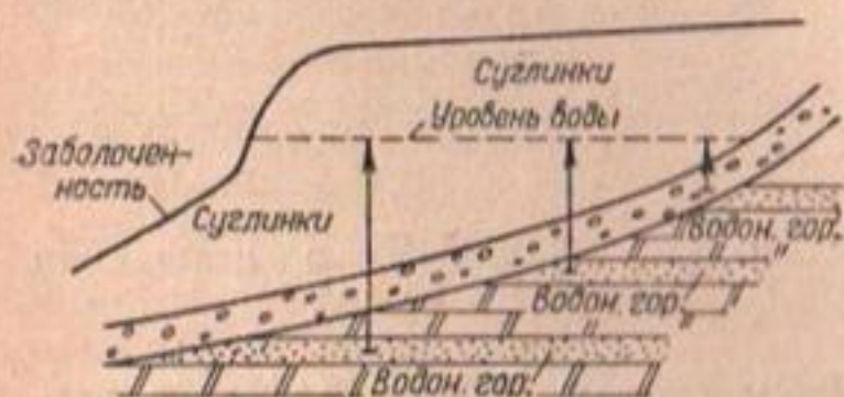
Фиг. 8. Заболачивание склона напорными водами
