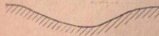
Фиг. 6. Заболачивание поверхностными водами
