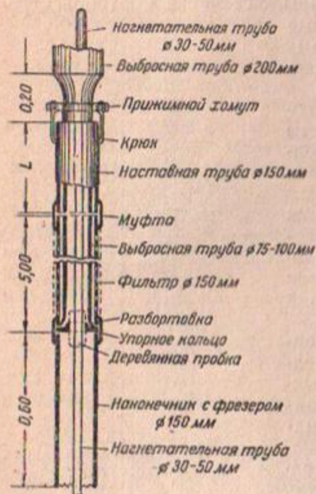
Фиг. 74. Трубчатый колодец „Союзводстроя“
