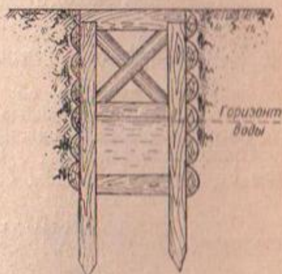
Фиг. 18. Дренажный лоток свайного типа усиленной конструкции
