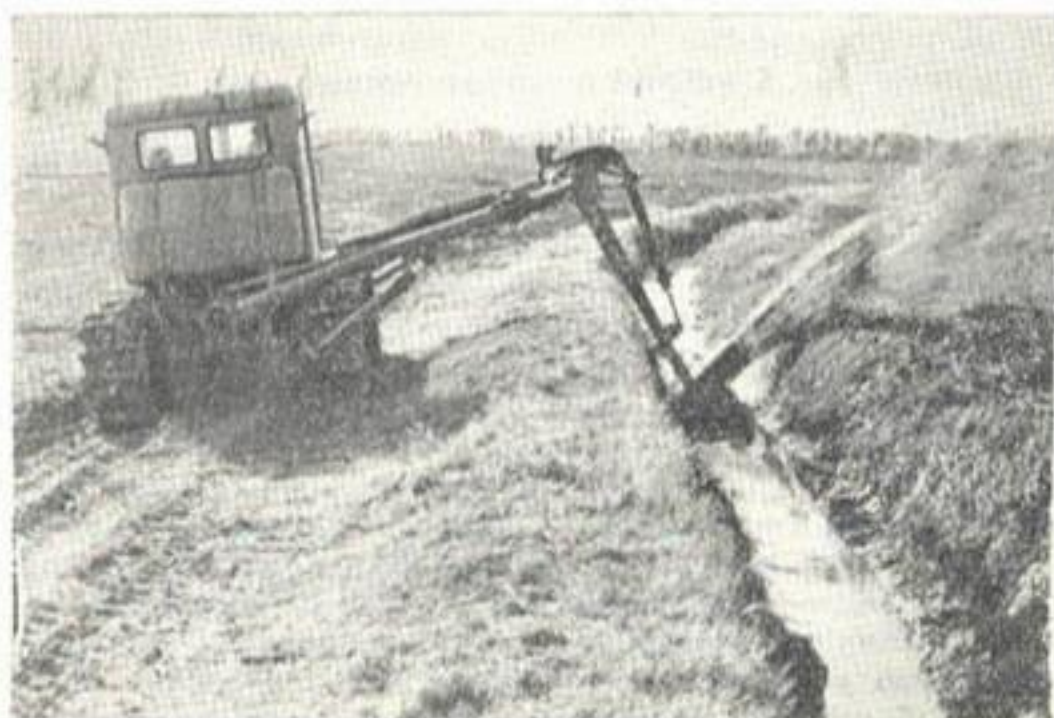
Рис. 4. Каналоочиститель Д-342А с роторным рабочим органом.
